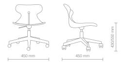
Sedia con seduta bianca e basamento con ruote in acciaio cromato. L'altezza della sedia è regolabile attraverso un sistema di regolazione a gas.
